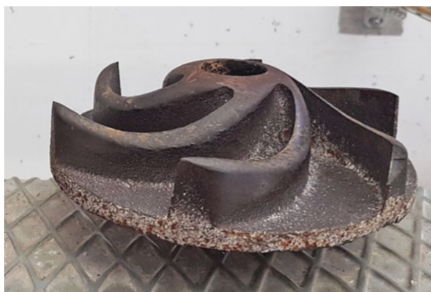
Ersatz Laufrad Schmutzwasser Freistromradpumpe des Abwasserpumpwerks 12 in Oberriet. Sieben Jahre und 50'000Std. im Einsatz bei einer Förderleistung im Neuzustand von 10 l/s.
